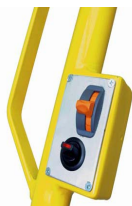
Fahrgeschwindigkeit (Vor/Zurück) ist stufenlos regelbar
