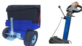
Bolzenkupplung mit Bowdenzug-Betätigung
